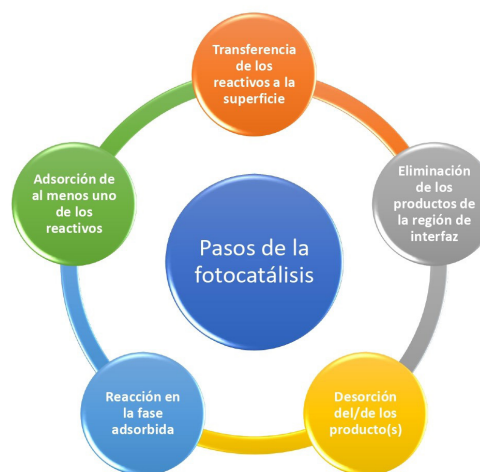
Fig. 2 Pasos fundamentales de la fotocatalisis.
